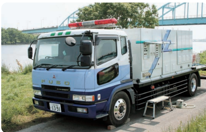
越水した内水をポンプ車で河川へ戻します。なんと1分間に、60mの内水を排出します。
