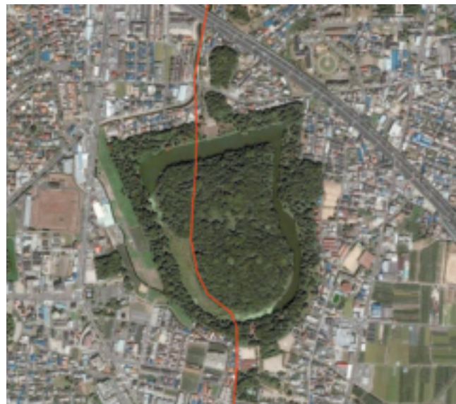
菅田山古墳（応神陵）付近の活断層 活断層の影響で墳丘が変形している。
